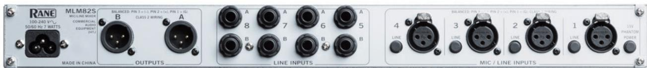
MLM82Sは、XLR端子と15V DCファンタム電源を備えた4系統のスタジオグレードのバランス・モノラルマイク/ライン入力を備えています。4系統のマイク/ライン入力はそれぞれA、A+B、B出力にアサインすることができます。独立したレベル/ゲイントリム・コントロールとシグナル/オーバーロード・インジケーターは、各マイク/ライン入力に用意されています。
