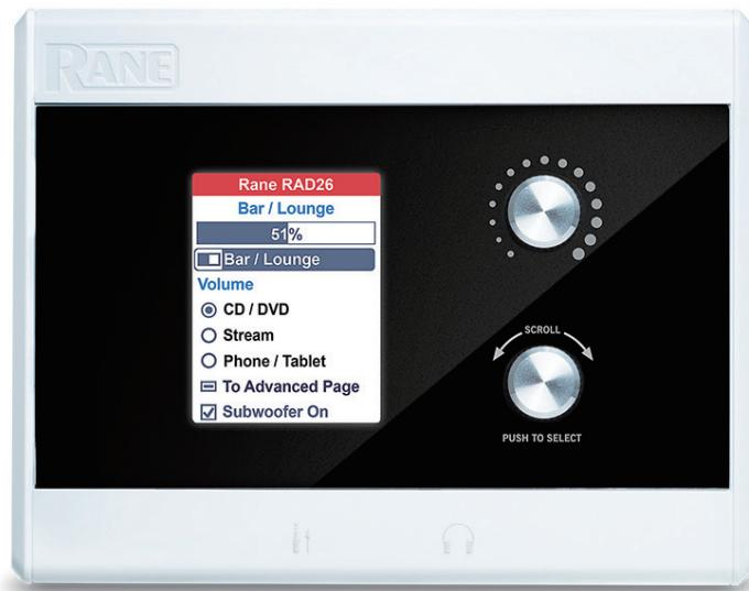
RAD26はカラーLCDディスプレイとゾーンコントロールノブを搭載しており、あらゆる場所でのコントロールが可能です。またラインレベル入力ジャック、ヘッドホン出力、およびデュアル4ワットアンプを備えており、各ゾーンのローカルニーズに応えることができます。
