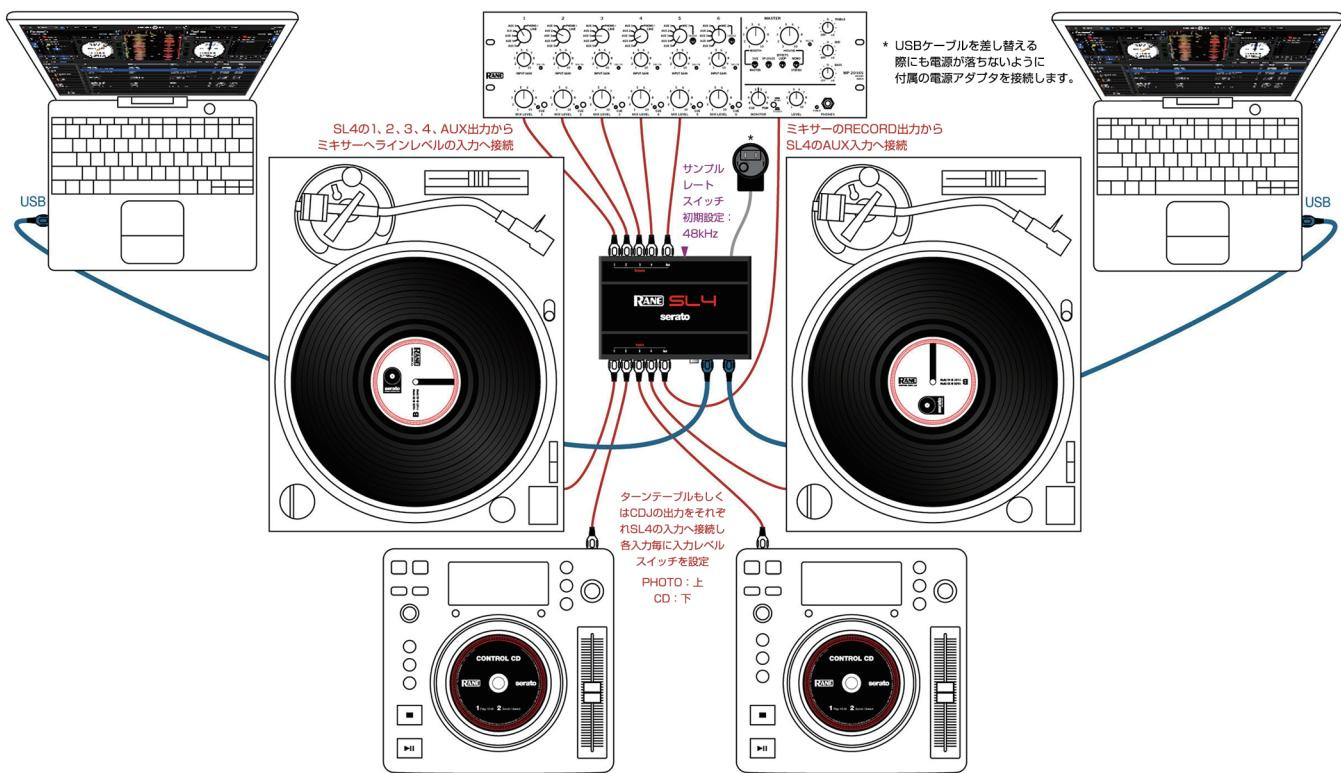
SL4 の機能を十分にお使い頂くためには 4 ~ 5 入力バスを搭載するミキサーをご利用いただくことをお勧め致します。SL4 の Aux 出力は、SP-6 サンプルプレーヤーの出力を独立してミキサーに入力するのに便利です。SL4 の Aux 入力は全てのパフォーマンスを録音するのに便利です。
