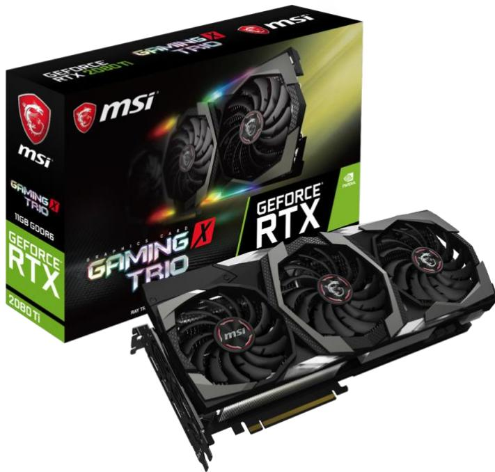
「GeForce RTX 2080 Ti GAMING X TRIO」は、OC モード時の最大ブーストクロックを 1775MHz にまで高め、Turing アーキテクチャを採用する GeForce RTX 2080 Ti の性能を最大限に引き出します。そのオーバークロック動作を支えるのが、MSI 独自設計のトルクスファンをさらに進化させたトルクスファン 3.0 を 100mm 径×2 と 90mm 径×1 構成の 3 連ファンにした TRI-FROZR 冷却機構の採用です。トルクスファン 3.0 は、分散型のファンブレードのひねりをさらに大きくすることでエアフローを加速し、冷却効率を向上させるとともに、従来型のファンブレードが大型ヒートシンクへのエアフローと空気の拡散を最大化し、GPU やメモリ、電源回路の冷却性を高め、GeForce RTX 2080 Ti の性能を最大限に引き出します。また、クーラーのフロント部には RGB LED を搭載し、発光色やパターンを自分好みに設定することができるほか、他の LED 搭載デバイスと同期させることもできます。
