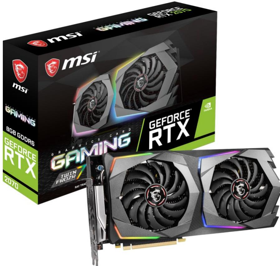
「GeForce RTX 2070 GAMING 8G」は、トルクスファン 3.0 を採用し、ヒートシンクの散熱効率を向上させた第 7 世代となる MSI 独自の冷却機構 TWIN FROZR 7 を搭載、従来モデルに比べて約 13% の冷却性能アップを実現したモデルです。これにより、GeForce RTX 2070 の性能を最大限引き出すとともに、安定したオーバークロック動作を可能にします。また、クーラーのフロント部には RGB LED を搭載し、MSI 独自のライティング制御ソフトウェアである Mystic Light により、好みの発光色やパターンを設定することができます。
