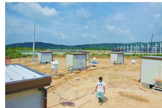
平成24年9月13日(木)～10月5日(土) @タイ、バンコク郊外のチャチュンサイ 住宅を想定したプレハブ式試験棟の屋根に、 高日射反射率塗料の実証試験を実施
