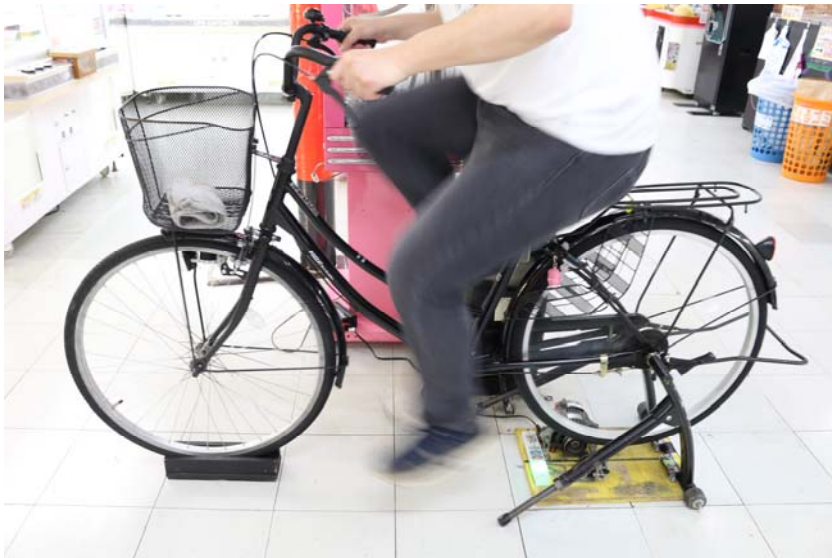
↑ 自転車発電機 (蓄電タイプじゃないので自転車が止まると台も停止します) (自転車を漕ぐとLEDが点灯して発電されます)
