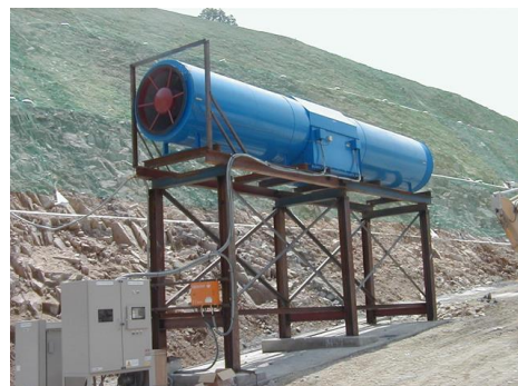
『エアロ★MAX』 定格風量：3000m 3 定格電圧：4.9kPa
