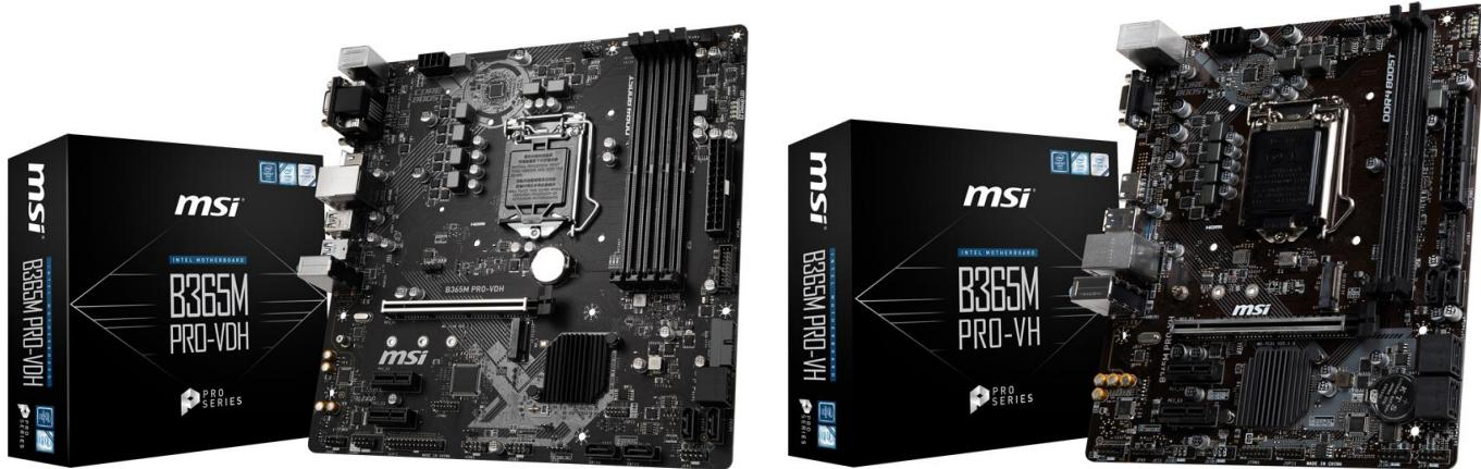
B365M PRO-VDH は、Steel Armor で強化を施した PCI-Express x16 スロットを備え、高性能グラフィックスカードもサポートする一方で、VGA や HDMI、DVI-D 出力を備えることで、旧式のプロジェクターなどの企業内資産を有効に活用することができます。また、USB 3.1 Gen1 ポートを従来の Intel B360 搭載製品より 2 ポート増やした 8 ポート(うち 2 ポートはピンヘッダ出力)、周辺機器との接続性を向上させています。その下位モデルとなる B365M PRO-VH は、CPU 内蔵グラフィックスの出力として VGA と HDMI に対応した標準モデルで、USB 3.1 Gen1 ポートを 6 ポート(うち 2 ポートはピンヘッダ出力)備えたモデルとなります。また、両製品とも PCI Express 3.0 x4 接続に対応した Turbo M.2 スロットを備え、高速なシステム起動を可能にします。
