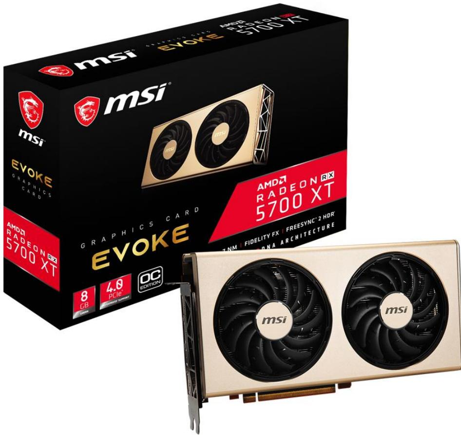
Radeon RX 5700 XT は、TSMC の 7nm プロセス技術を採用するとともに、GPU アーキテクチャを RDNA アーキテクチャに刷新し、クロックあたりの性能を向上させるとともに電力効率を向上。さらに、より高クロックな動作を可能にすることで、ゲームパフォーマンスを大幅に向上させています。この Radeon RX 5700 XT は、2560 基のストリーミングプロセッサを統合し、256bit GDDR6 メモリインターフェースに 14Gbps のメモリ帯域を実現する 8GB のグラフィックスメモリを搭載。また、世界初の PCI Express 4.0 x16 対応を果たし、第 3 世代の AMD Ryzen プロセッサおよび AMD X570 プラットフォームと組み合わせることで、GPU の性能を最大限引き出すことができます。
