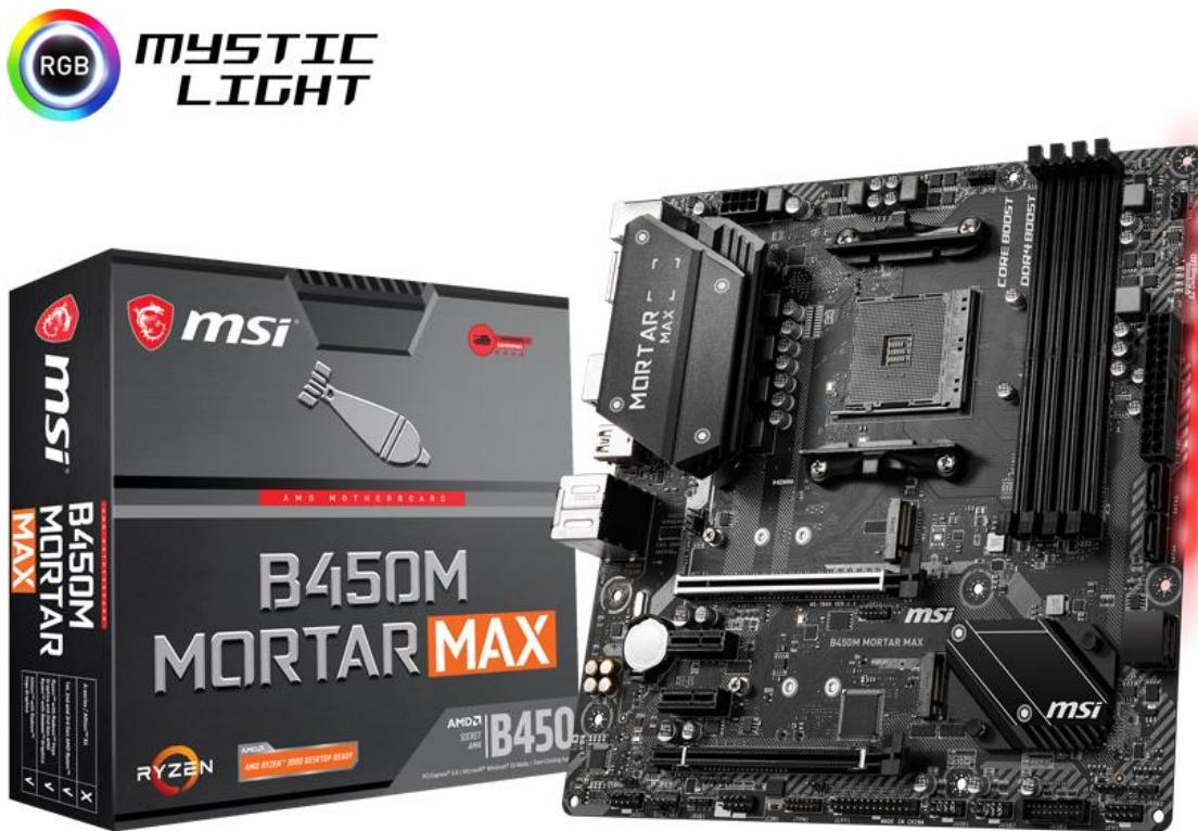
B450M MORTAR MAX は、AMD B450 チップセットの機能をフルに活かしたスタンダードな GAMING マザーボードで、Micro-ATX マザーボードながら PCI Express 3.0 x4 接続による最大 32Gbps の高速転送速度を実現する Turbo M.2 スロットに加え、チップセット接続による PCI Express 2.0 x4 接続の M.2 スロットを備え、高速ストレージの搭載による快適なゲーム環境を構築することができます。また、PCI Express x16 スロットには、Steel Armor による補強と EMI/静電保護が施され、重量級グラフィックスカードと組み合わせることで高性能な GAMING システムの構築をサポートするほか、2-Way AMD CrossFire によるマルチ GPU 環境もサポートします。
