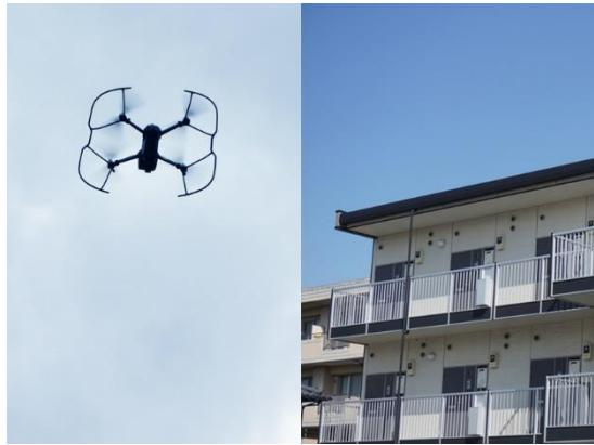
さくら事務所では建物を熟知した建築士のベテランインスペクターが自ら操縦するドローンで屋根の上空からの確なポイントを空撮。映像から劣化の程度、不具合の有無を診断します。例えばドローン撮影の結果「屋根が錆びている、割れている」などの不具合が発見された場合、居住中でなければ同じ箇所の最上階屋根裏をインスペクターが調査することも可能。「シミ」などを確認できれば雨漏りの可能性が強くなります。修繕のアドバイスもその場のワンストップで行うことが可能。劣化しやすい場所であり目視に限界のある、屋上の不具合有無を知ることで、売買や修繕計画、融資資料としても役立てられます。
