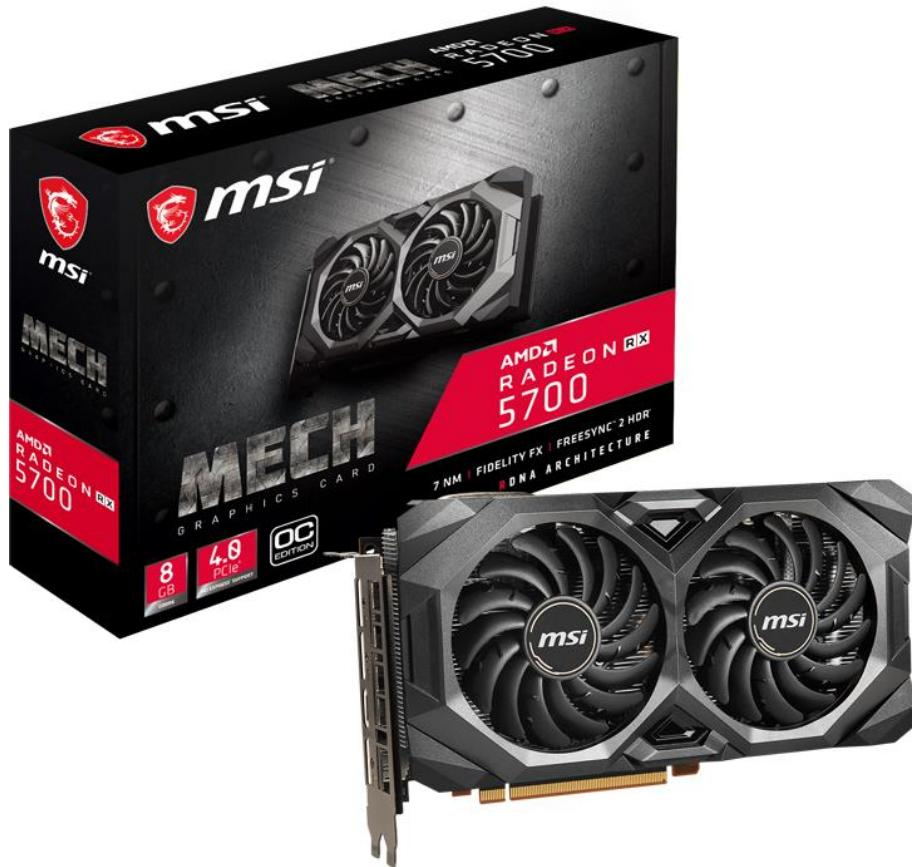
開発コードネーム“Navi”で知られる Radeon RX 5700 は、クロックあたりの性能を向上させるとともに電力効率を引き上げ、より高クロックな動作を可能にした GPU アーキテクチャ“RDNA”を採用し、ゲームパフォーマンスを大幅に向上させています。本 GPU は、TSMC の 7nm プロセス技術を採用し、2304 基のストリーミングプロセッサを統合するとともに、256bit GDDR6 メモリインターフェースに 14Gb/s のメモリ帯域を実現する 8GB のグラフィックスメモリを搭載。また、世界初の PCI Express 4.0 x16 対応を果たし、第 3 世代の AMD Ryzen プロセッサと AMD X570 プラットフォームと組み合わせることで、GPU の性能を最大限引き出すことができます。
