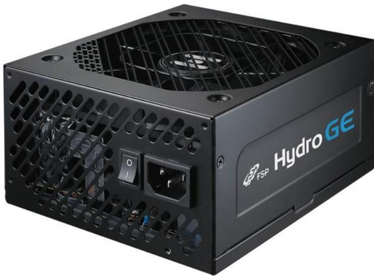
Hydro GE シリーズは、ゲーミング PC を組み上げるために最適な電源ユニットとして、電源内部の冷却性を高め、安定した電力供給を実現するとともに、静音性にもこだわった 80PLUS GOLD 認証のフルモジュラー型 ATX 電源です。本シリーズでは、最新のハイエンドマザーボードが複数の CPU 電源入力を要求していることを受け、8 ピンと 4+4 ピンの 2 種類の CPU 用補助電源をサポートしています（なお、550W モデルにつきましては、4+4 ピンのみとなります）。また、静音性と耐久性にすぐれた 135mm 径の流体軸受けファンを採用するとともに、通気口を非対称のメッシュ構造にすることによって、風切り音を防ぎ、ノイズレベルを低減することに役立てています。さらに、750W と 850W モデルについては、周辺温度を検知して、自動的にファンの速度を切り換えるインテリジェント速度制御回路を搭載し、効率的な冷却と静音性を両立させています。
