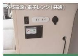
外部電源/電子レンジ(共通) 携帯の充電など、家庭用の電子機器を使えるようにする変換器
