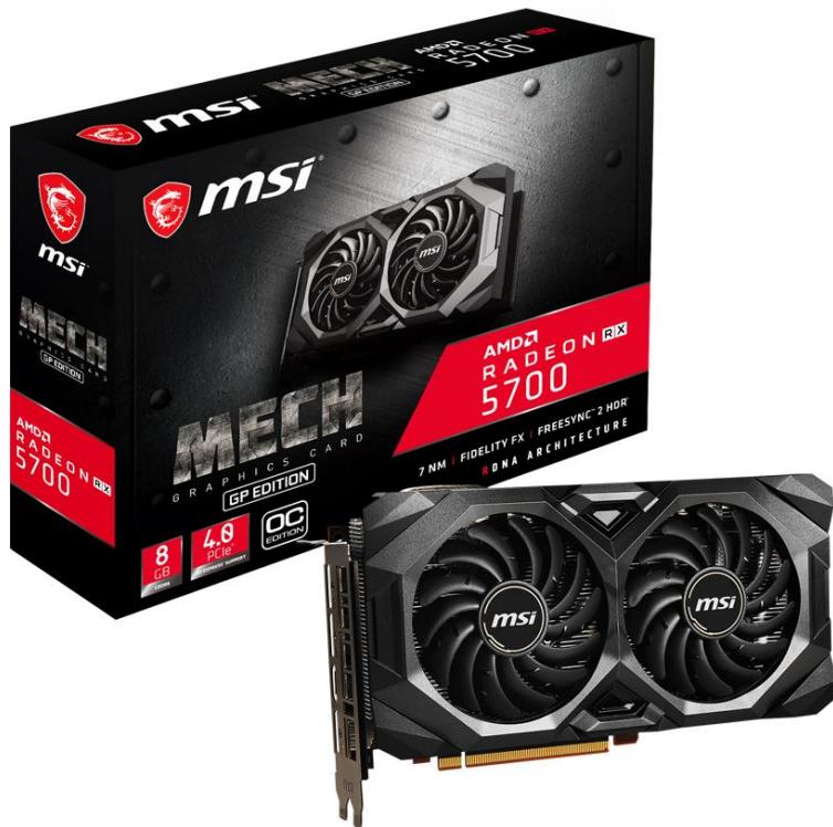
「Radeon RX 5700 MECH GP OC」は、「Radeon RX 5700 MECH OC」の後継モデルにあたり、補助電源コネクタを8ピン+6ピンに変更するなどの改良を加え、より安定したオーバークロック動作を実現しました。MSI 独自設計基板を採用するとともに、冷却機構にトルクスファン3.0を2基搭載するデュアルファン機構を採用。トルクスファン3.0は、分散型ファンブレードのひねりをさらに大きくすることでエアフローを加速し、冷却効率を向上させるとともに、従来型ファンブレードが大型ヒートシンクへのエアフローと空気の拡散を最大化、GPUやメモリ、電源回路の冷却性を高めています。基板背面にはカードのたわみを防止するバックプレートを備えています。
