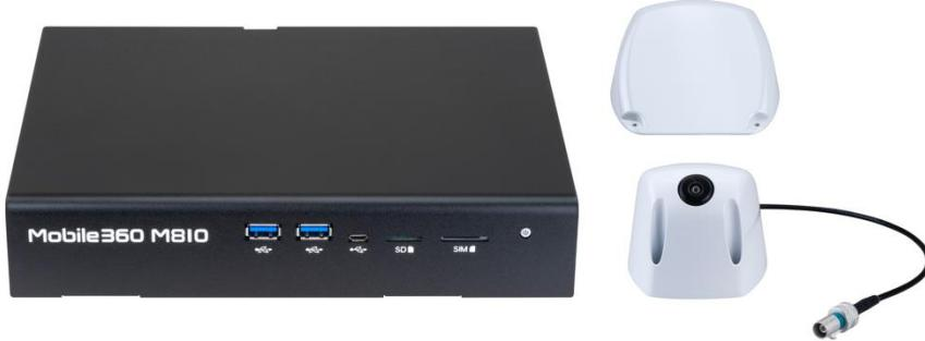
最先端のAIおよびコンピュータービジョンテクノロジーにより、VIA Mobile360 M810は、前方衝突警告、死角検知および車線逸脱警告を含む先進運転支援システム(ADAS: Advanced Driver Assistance System)機能を全範囲をサポートし、差し迫ったリスクをリアルタイムでドライバーに警告し、潜在的な事故を防ぐために迅速に行動できるようサポートします。また、動的移動物体検出および駐車アシスタンツシステムの機能は、FOV-190° リアビューカメラと組み合わせることで有効にすることができます。
