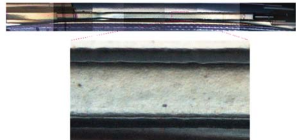
宇宙で酵素合成されたセルロース 微小重力下で均一にセルロースが合成されている
