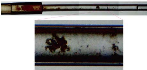
地上で酵素合成されたセルロース 沈澱が生じ不均一に合成されている様子が分かる
