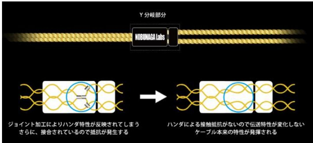
接続機器の性能を最大限に発揮するバランス接続（※初・雋対応。画像は4.4mm 5極時の対応例を記載）
