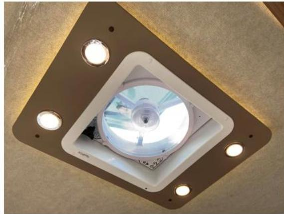
車両の受検者側スペースの天井には換気扇が取り付けられ、これにより車内にウイルスが滞在することを防ぎます。キャンピングカーに搭載されているサブバッテリーで使用するため、電源が取れない場所でも換気が可能です。
