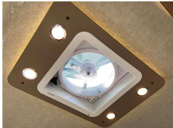
コロナウイルス患者の乗車する後部スペースの天井には換気扇が取り付けられ、これにより車内にウイルスの滞在を抑制する事が可能です。キャンピングカーに搭載されているサブバッテリーで使用するため、電源が取れない場所でも換気が可能です。
