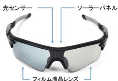
eShades (イーシェード) の仕組み
