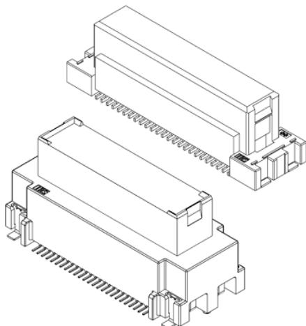
厳しい振動環境での使用を想定した機器内接続用0.8mmピッチ、Z可動（Z-Move™）フローティングタイプ平行接続BtoBコネクタ。可動（フローティング）構造でX-Y方向に0.5mm可動。Z方向は0.02mmの共振振幅と0.5mmの有効嵌合長。タフな環境でも確実に異物の除去を行う2点接点コンタクト採用。高温環境下での使用に耐える125°C対応製品。イリソ独自のフローティングテクノロジー「Z-Move™（ジームーブ）」を採用。接点が固定されたままZ方向に可動し共振・衝撃による接点ズレを防ぐ耐振動性、耐衝撃性に優れたコネクタです。狭ピッチの採用により、従来の10120シリーズに対し省スペース化を実現しました（約50%削減）。
