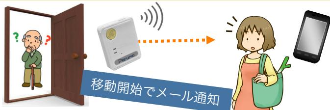
パルモどっち君2は、加速度センサーを内蔵し、本体が移動するとその振動を感じます。これをトリガーとして、LEDで表示します。また、予め設定した相手先にメール通知します。（最大5箇所）
