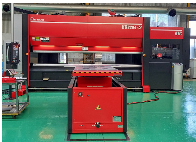
＜新ベンダー全景：右側に自動金型交換装置が付帯＞
