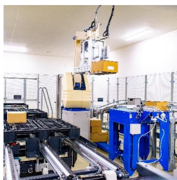
製品倉庫棟「パレタイジングロボット」
