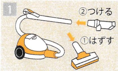
本体を掃除機のノズル口に向きを確認して取り付ける。
