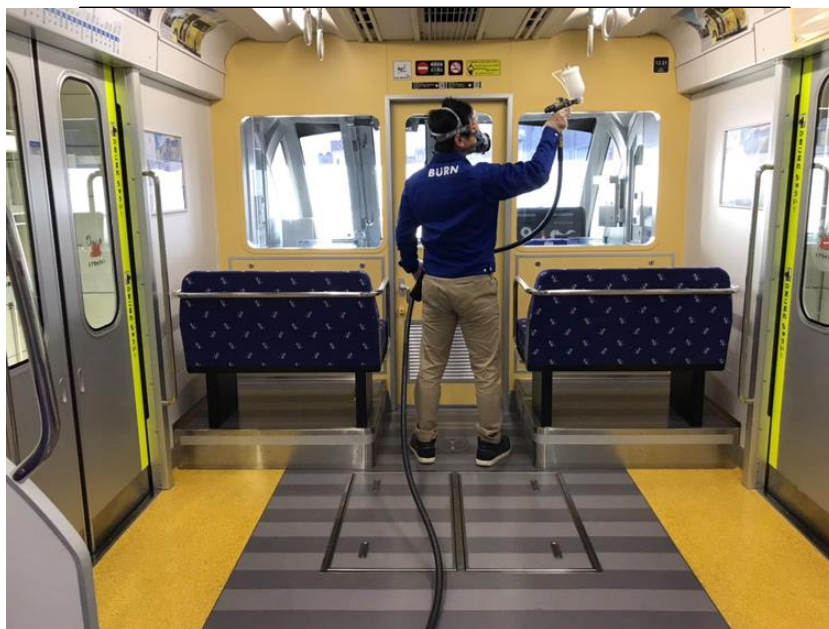
抗ウイルス抗菌コーティング（「レコナ エアリフレッシュ」） ゆいレール車両内の作業の様子
