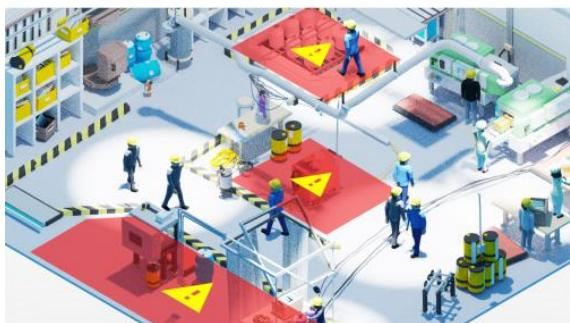
カメラの全画角の場合、検知アラートが多数発生する場合があり、本当に検知したい「人」を見落としてしまいます。ViewLED ソリューションの侵入検知では、人の立ち入りを監視したい「危険なエリア」と、危険な機械などが配置されている「機械エリア」を併せて設定することで、より詳細な条件での侵入検知を実現することができます。
