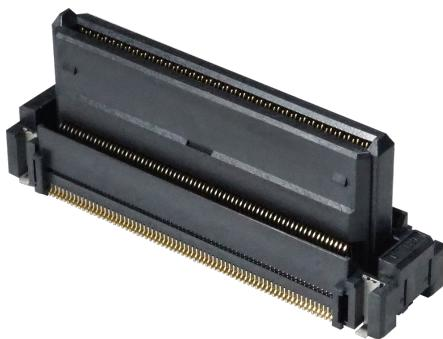
業界最大クラスの可動幅を持つ0.5mmピッチ、フローティングタイプ平行接続 (ST／ST) 基板対基板 (BtoB) コネクタ (ソケット)。フローティング構造でXY方向に1.2mm可動。製品ピッチの0.5mm対し2倍以上の可動幅を実現。Z方向は±0.5mmを有効嵌合長で吸収。既存製品の10106Bシリーズとの嵌合で多彩なラインアップにお応えいたします。
