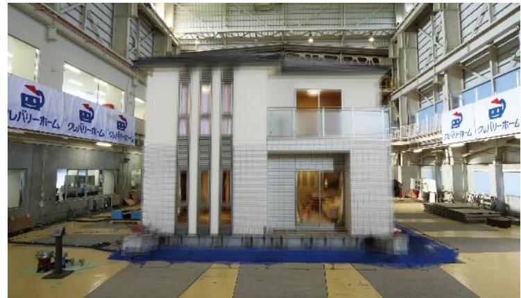
結果、最大1791ガルという極限的な地震波を受けたあとでも、土台、柱、梁、構造用合板などの主要構造用部材、外壁タイル共に損傷は認められませんでした。内装の一部に軽微な破損がありましたが、簡易な補修のみで今後も使用できる状態であることが確認され、プレミアム・ハイブリッド構法の高い耐震性が実証されました。
