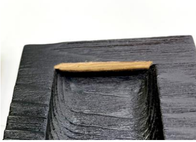
ウレタン塗装のみの場合の剥離実験
