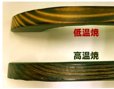
燃焼温度による色と凹凸の違い
