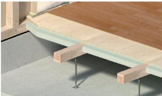
床下 湿気の溜まりやすい床下には、吸水率が低く耐久性に優れたポリスチレンフォームを採用。建てた当時の高い断熱性能をいつまでも維持します。
