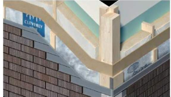
外壁 外壁には、厚みいっぱい充填した断熱材や気密処理に加え、輻射熱を遮る遮熱シートを採用することで、高い気密性・断熱性・遮熱性を表現しています。
