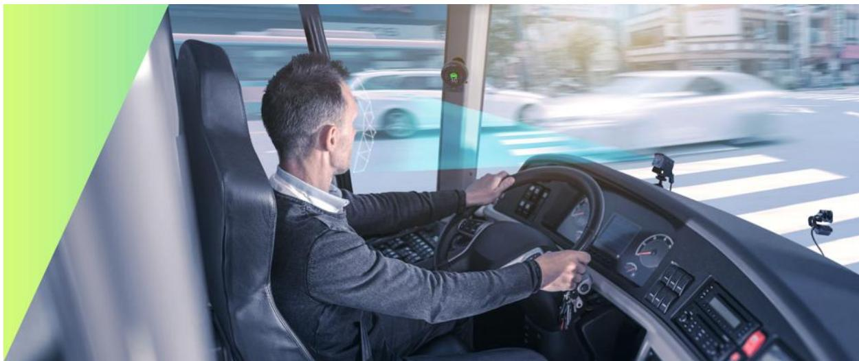
「VIA Mobile360 M800」は、IP67規格に準拠した超小型のシステム、フロントADASカメラ、ドライバーモニタリング用室内カメラで構成され、運行管理者がさまざまな車両タイプに装置を設置し、道路前方に潜む危険や、ドライバーの注意散漫、眠気、スマートフォンの使用、喫煙などの兆候を検出するために、カメラを最適な位置に配置するために必要な柔軟性を提供します。また、オプションのADASディスプレイは、自車の前方に危険な範囲に入ってくる歩行者などをシステムが検知した際に、ドライバーにタイムリーに視覚と音声による警告を行ないます。
