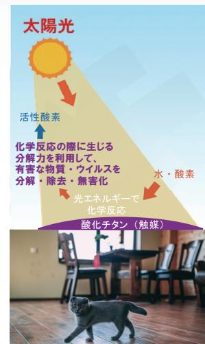
光触媒は、酸化チタンなどの光触媒半導体金属を【触媒】に、光エネルギー（紫外線）を使って空気中の水と酸素から活性酸素を作りだします。光触媒塗料はその仕組みを活用し、環境に優しい安全性すでに私たちの生活環境のあらゆる場面で幅広く利用され始めています。
