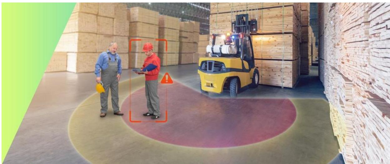
VIA Mobile360 フォークリフト・セーフティ・システム 3PD パッケージは、車両に接近した人を検知すると音声で警告を発し、歩行者との衝突を防止します。本システムは、リアカメラ 1 台とサイドカメラ 2 台を搭載し、カメラ設置の高さに応じて 4~5 メートルのエリアをカバーする 270 度の人物検出ゾーンに対応し
