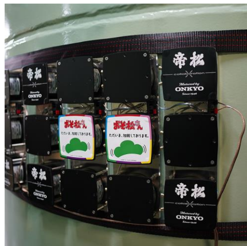
専用の大型タンクに取り付けられた加振設備
