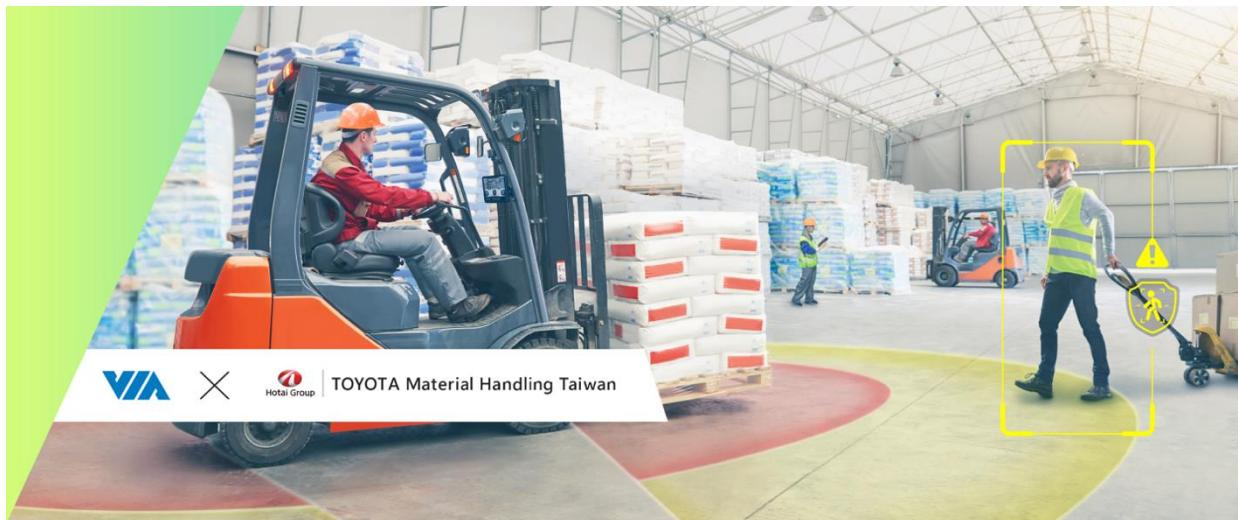
VIA Mobile360 フォークリフト・セーフティ・システムは、2PD(人物検知) + DSS(ドライバー・セーフティ・システム)構成で利用可能です。フロントおよびリア PD カメラにより、作業員や歩行者などが車両に近づきすぎたと検知すると自動的にドライバーに警告を発します。カメラの設置高に応じて、4~5 メートルの範囲を 60~120° のレンジでカバーする人物検知ゾーンに対応します。VIA Mobile360 WorkX アプリは、カメラのキャリブレーションとシングルまたはデュアルアラートの選択を迅速かつ便利に設定します。
