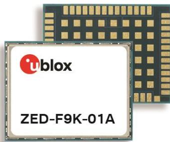
2022年11月22日、スイス、タルヴィルースイスの u-blox AG (日本法人: ユーブロックスジャパン株式会社、東京港区、代表入山銳士) は、先進のハードウェアとソフトウェアおよび最新世代の IMU (慣性計測装置) を内蔵し、高度な自己完結型測位ソリューションを提供する高精度 GNSS モジュール、u-blox [ZED-F9K-01A](#) を発表しました。このモジュールは L1/L2/E5B と L1/L5 の両帯域をサポートすることで極めて高い柔軟性と衛星信号の可用性、セキュリティを実現しています。マルチバンドとマルチコンステレーション GNSS (全地球測位システム) 技術および
