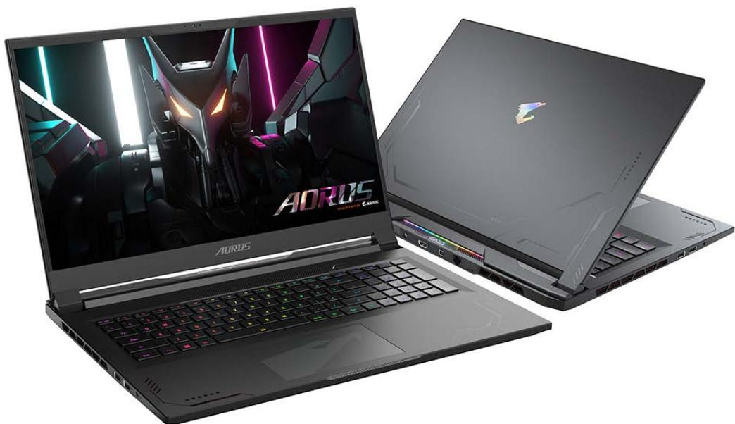
「AORUS 17X AZF-D5JP665JP」が搭載するモバイル版第13世代Intel CoreプロセッサシリーズのフラグシップIntel Core i9-13980HX(ベースクロック2.2GHz、Turbo Boost時最大5.6GHz)は、Intelとしては第3世代となる10nmプロセス技術Intel 7で製造され、CPUコアに処理性能を重視する8個のパフォーマンスコアと、処理効率を重視する16個の効率コア(Eコア)を組み合わせた24コア/32スレッド構成を採り、すぐれたパフォーマンスと省電力性を両立。高性能なゲーミングPCとしてだけでなく、モバイルワークステーション用途でもすぐれたパフォーマンスを発揮します。また、GPUにはAda Lovelaceアーキテクチャを採用した最新のNVIDIA GeForce RTX 4090 Laptop GPU GDDR6 16GB(最大ブーストクロック2040MHz、最大消費電力175W)を採用し、最高のグラフィックス性能を引き出します。
