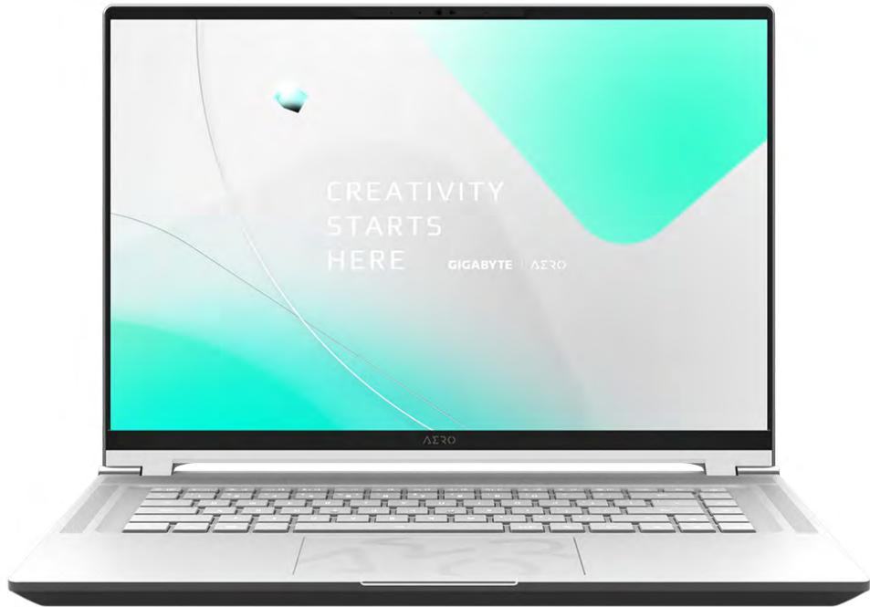
「AERO 16 OLED BSF-H3JP994SP」は、CPUに10コア/16スレッドの第13世代Intel Core i7-13620Hプロセッサ(ベースクロック2.4GHz、Turbo Boost時4.9GHz)、GPUにAda Lovelaceアーキテクチャを採用したNVIDIA GeForce RTX 4070 Laptop GPU GDDR6 8GB(最大ブーストクロック1980MHz、最大消費電力105W)をそれぞれ搭載した製品です。筐体は、CNC加工されたアルミニウム合金製ボディで耐久性と強度を向上、優れた精度と流れるようなボディラインで完璧な精密さを体现します。
