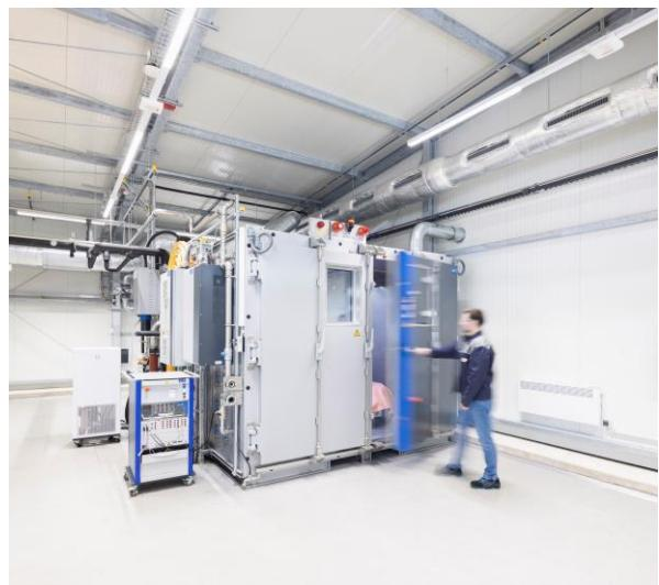
バッテリーテストセンター内では、恒温恒湿室で稼働中のバッテリーに対して幅広い温度・湿度での試験が実施されています。
