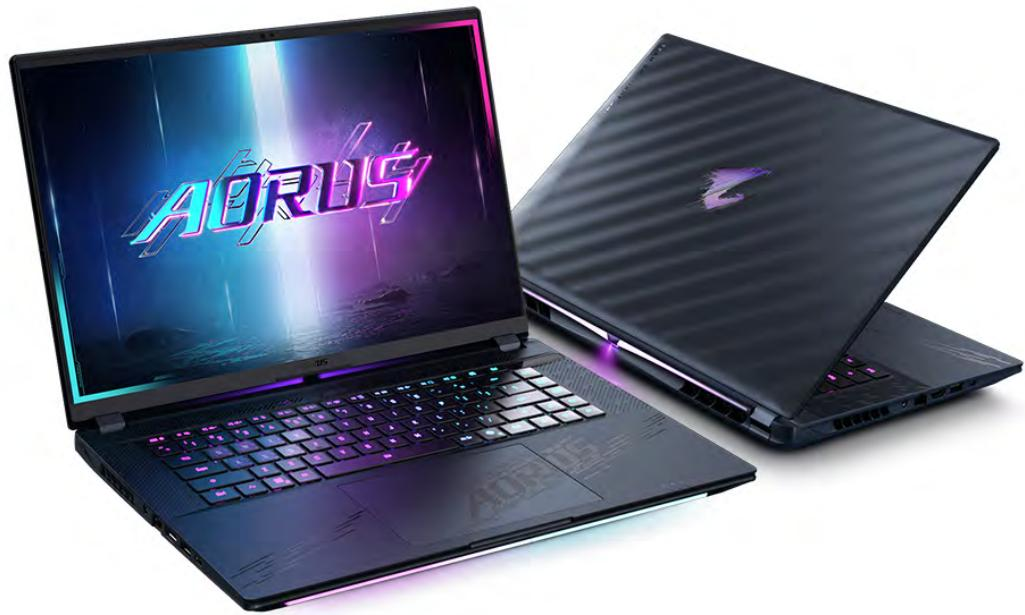
AORUS MASTER 16シリーズは、CPUに開発コードネームArrow Lakeで知られるIntel Core Ultra 9 275HXプロセッサを採用しています。8基のPerformanceコア(Turbo Boost時最大5.4GHz)と16基のEfficientコア(Turbo Boost時最大4.6GHz)の24コアに加え、AIアクセラレータNPUのIntel AI Boostを搭載し、AI性能の向上を果たしています。
