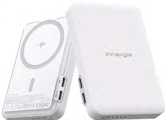
Innnergie Qi2 45Wでは、従来のワイヤレス充電規格であるQiの最大出力が7.5Wだったところ、最新規格のQi2に対応することで最大15W出力に対応し、iPhoneなどのデバイスの充電時間を大幅に短縮することができます。また、USB-Cポートを2つ備え、PD3.0およびQC4+充電規格に対応することで、ノートPCなどのデバイスで、最大45W(20V/2.25A)出力による急速充電が可能です。さらに、ワイヤレス充電とUSB-C充電を組み合わせ、最大3台の同時充電もサポートし、ワイヤレスで5W、USB-Cで30W+10W出力が可能となります。もちろん、モバイルバッテリを充電しながら、ほかのデバイスを同時充電可能なパススルー技術も搭載しており、用途に合わせた使い分けができます。本体サイズは102×68×17.2mm、本体重量は220gで、吸着面にはQi2側にシリコン素材を採用するほか、Qi2側は1100gの強力な磁力によりデバイスをしっかりと固定、背面にも900gの磁力を持たせることでスタンドやカードホルダーなどのアクセサリも安心してご利用いただけます。
