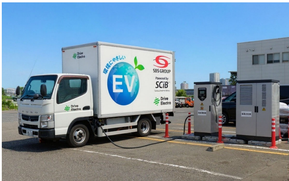
既存ディーゼルトラックを電動化改造した EV トラック
